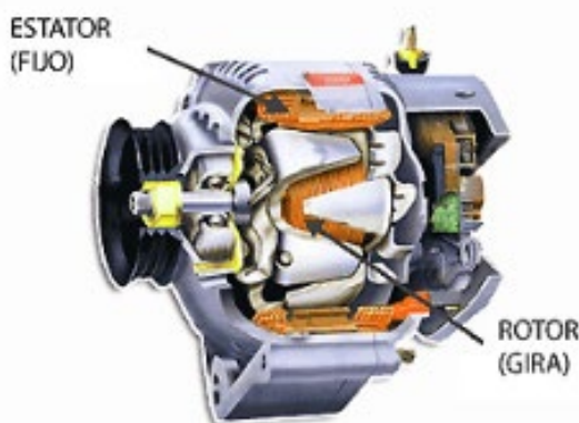
Figura 27. Estator y rotor de un alternador de corriente continua.
