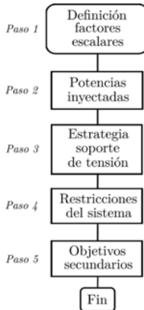
Figura 5.9. Diagrama de flujo para el diseño de estrategias de control de corriente flexibles.
